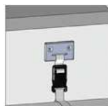
Sicherheitsclips Wandbefestigung Serienmässig
