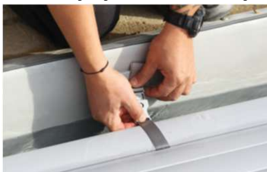
Ohne Autofix, manuelle Verriegelung der Sicherheitsclips
