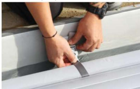
Ohne Autofix, manuelle Verriegelung der Sicherheitsclips
